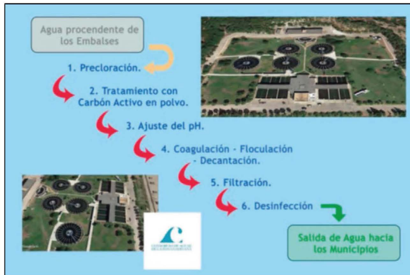
Figura 4. Tratamientos de la ETAP El Montañés. Fuente: Plan de Gestión del Riesgo por Sequía de Cádiz.
