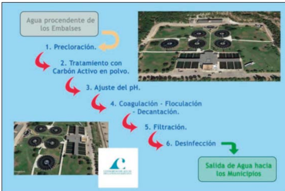
Figura 24. Tratamientos de la ETAP El Montañés. Fuente: Plan de Gestión del Riesgo por Sequía de Cádiz.
